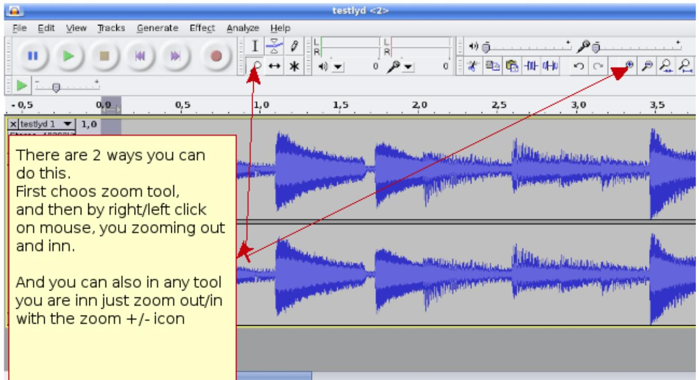
2. 次にノイズ部位をマークします。マウスの左ボタンを押し続けて、ドラッグして部位を選択します。
