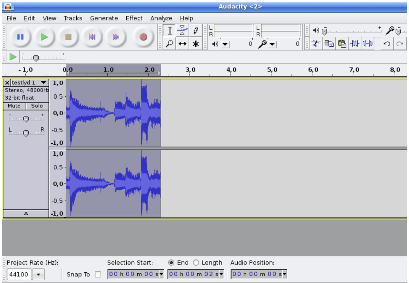
録音部位の音量が調整できました。音割れを防ぐには、低めで録音してから Audacity に後で調整させるのがよいでしょう。次はマイクの背景ヒス音などのノイズの除去を試みましょう。まず録音トラックで除去したい「ノイズプロフィール」を設定します。
